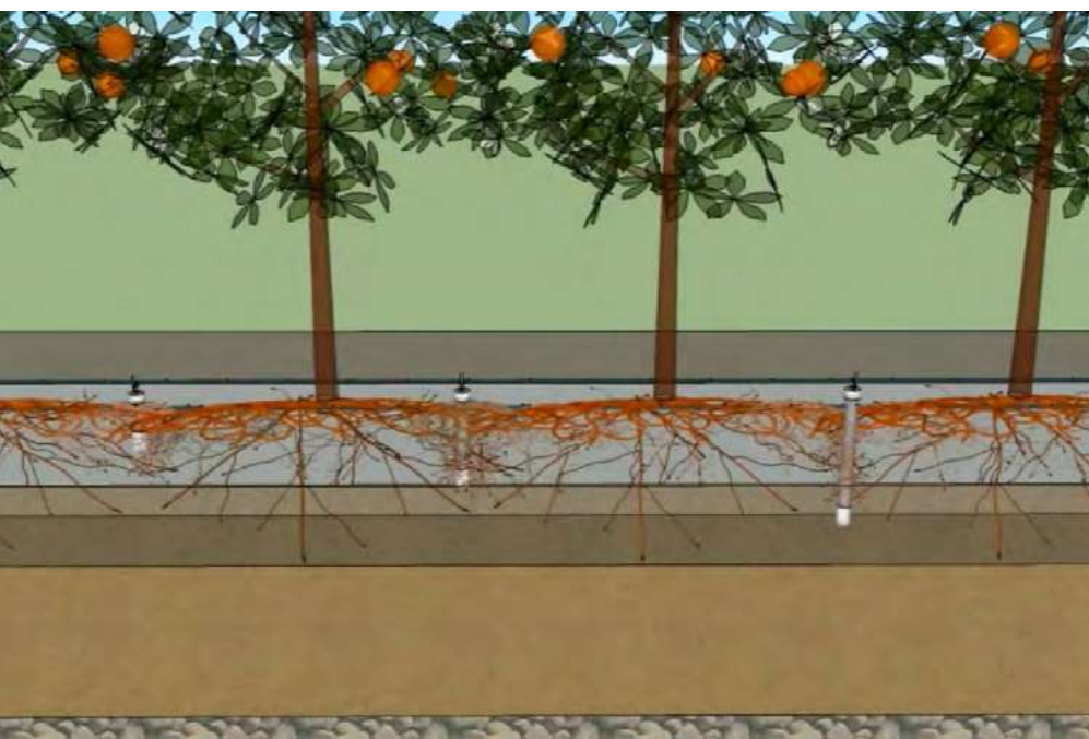
Figura 2. Diagrama de ubicación de sondas lisimétricas de succión de solución de suelo a distintas profundidades del perfil.
