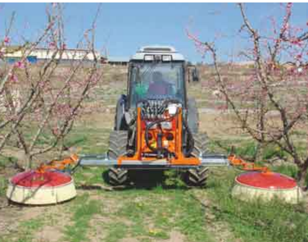
Aplicación de herbicidas con campana antideriva de 90.
