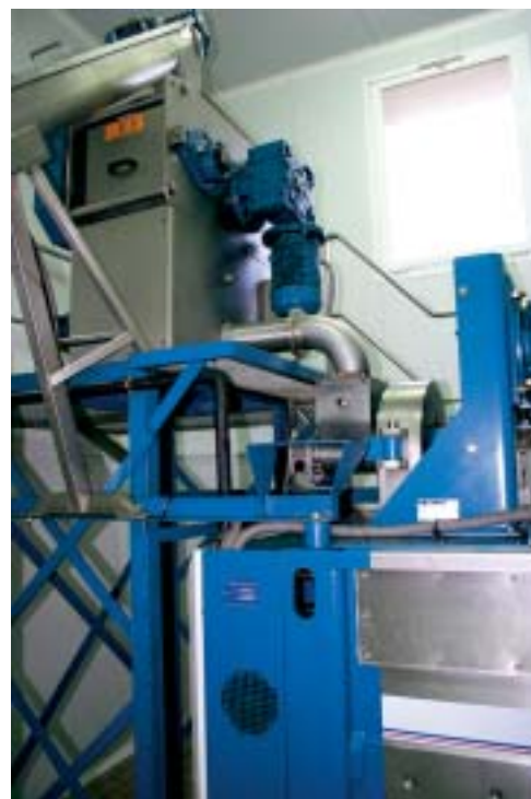
Molino de piedras conectado a otro de discos
