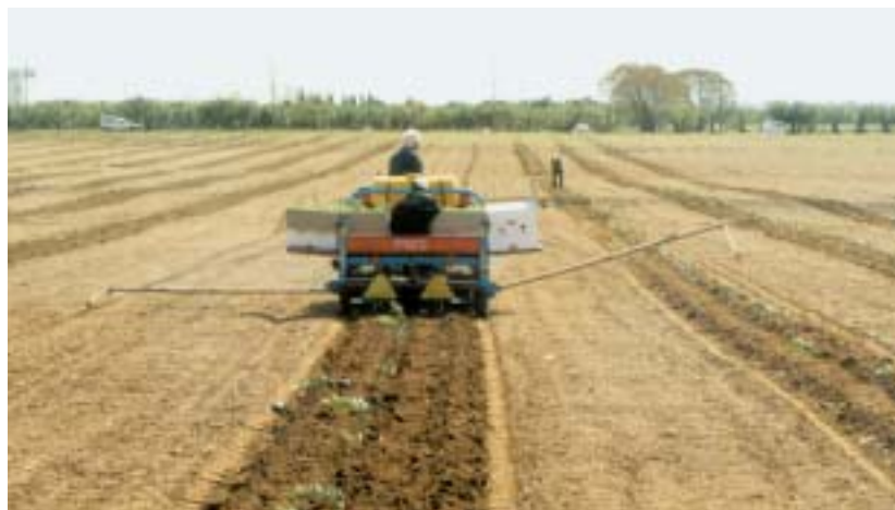
Vista dorsal de la máquina de un surco con los brazos marcadores
