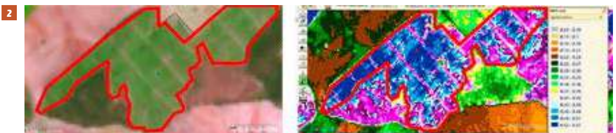
FIGURA 1 (Superior) Secuencia temporal de imágenes de los satélites Sentinel 2 para para la parcela de almendro de la ortofoto superior izquierda. Evolución a lo largo del año del índice de vegetación NDVI para el punto señalado en la imagen (valor correspondiente a 100 m 2 , tamaño de pixel de los satélites Sentinel 2 10 x 10 m).
