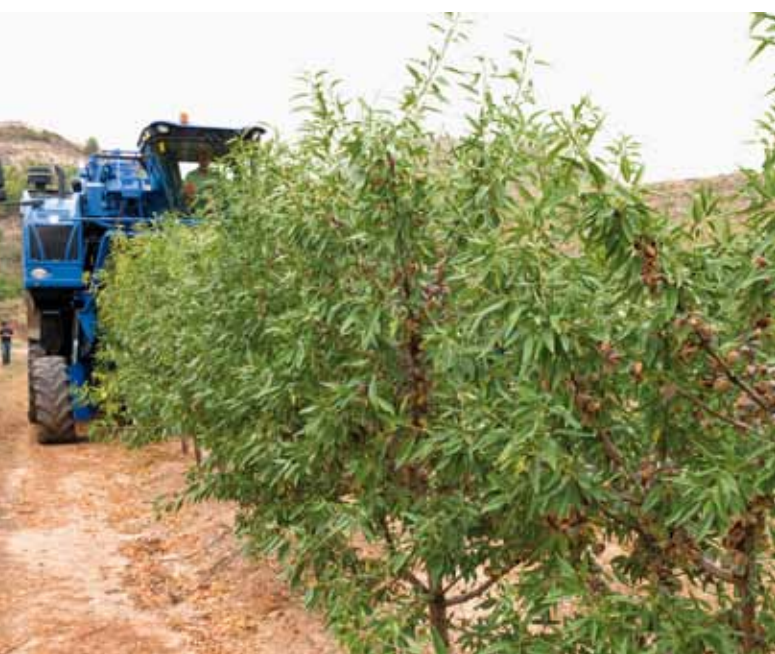
Foto 6. Recolección de almendra con la New Holland "Olive" de la compañía Fitasem.
