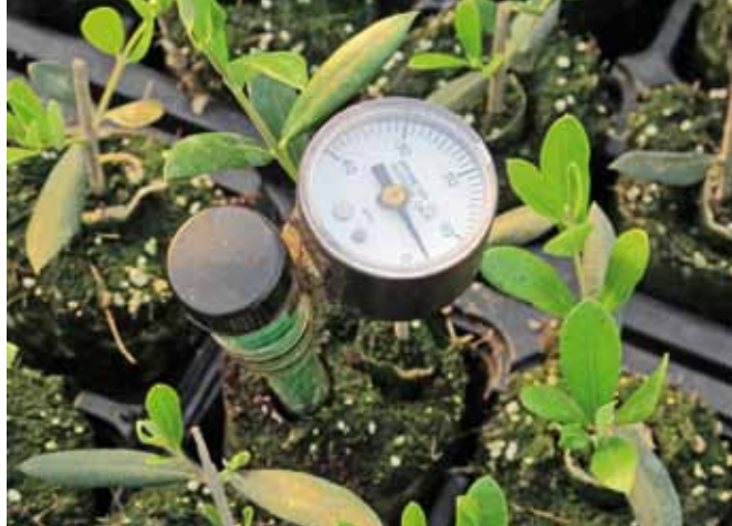
Detalle del tensiómetro
