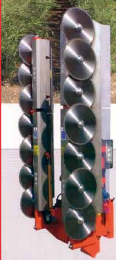
Barra de corte [ FL400U ] a cuchillos con troceador de sarmientos y palpador automático para faldones de olivos en cultivo superintensivo
