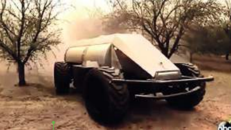
La disponibilidad de equipos de pulverización autónomos es un paso más hacia la automatización de tareas rutinarias en las explotaciones frutícolas como la protección del cultivo. En las fotografías las dos versiones propuestas por GUSS (California-USA) para baja (izda.) y alta densidad de plantación (dcha.). Fotos: GUSS, California -USA.
