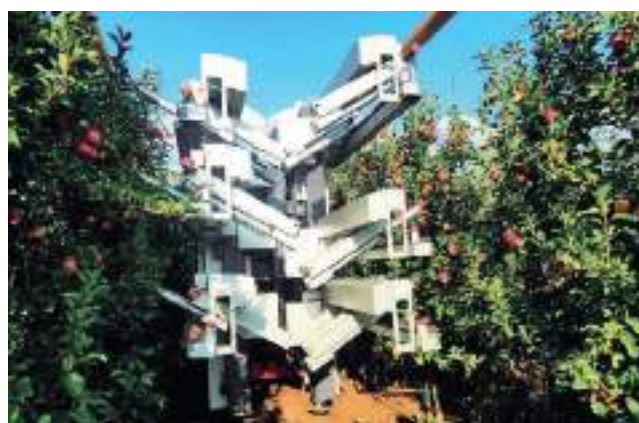
La disponibilidad de equipos de pulverización autónomos es un paso más hacia la automatización de tareas rutinarias en las explotaciones frutícolas como la protección del cultivo. En las fotografías las dos versiones propuestas por GUSS (California-USA) para baja (izda.) y alta densidad de plantación (dcha.). Fotos: GUSS, California -USA.
