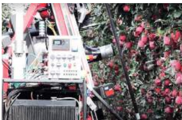
La disponibilidad de equipos de pulverización autónomos es un paso más hacia la automatización de tareas rutinarias en las explotaciones frutícolas como la protección del cultivo. En las fotografías las dos versiones propuestas por GUSS (California-USA) para baja (izda.) y alta densidad de plantación (dcha.). Fotos: GUSS, California -USA.
