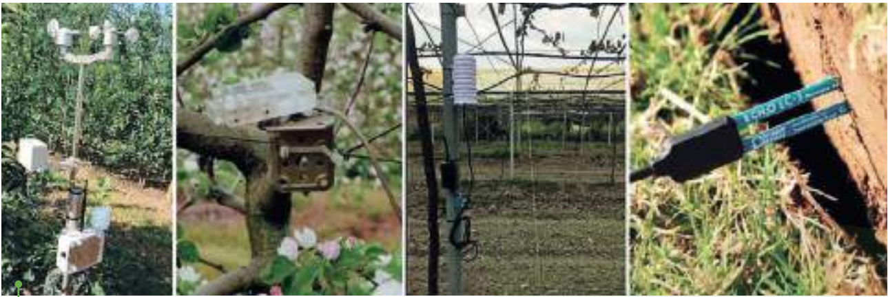
Estaciones meteorológicas, sensores de humedad, de temperatura ambiente, de hojas, frutos y estado hídrico del suelo, son claves para la monitorización del cultivo y de las condiciones edafo-climáticas en tiempo real, para el uso más eficiente y sostenible del agua, fertilizantes y productos fitosanitarios.
