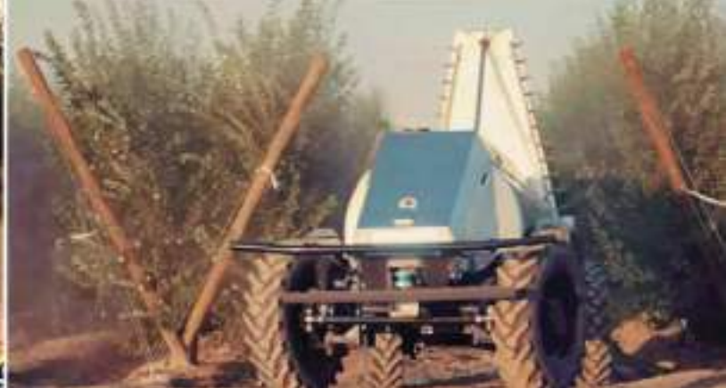
La disponibilidad de equipos de pulverización autónomos es un paso más hacia la automatización de tareas rutinarias en las explotaciones frutícolas como la protección del cultivo. En las fotografías las dos versiones propuestas por GUSS (California-USA) para baja (izda.) y alta densidad de plantación (dcha.). Fotos: GUSS, California -USA.
