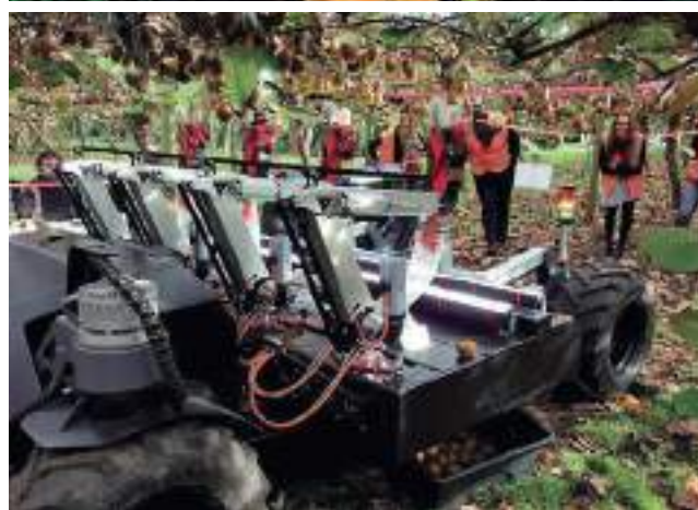
La recolección, por su alto requerimiento en mano de obra, ha sido la primera tarea objeto de robotización en manzana por varias empresas como Abundant Robotics (USA), FF Robotics (Foto: FF Robotics) y Tevel (Israel), de izda. a dcha. y de arriba abajo. Abajo dcha. recolección de kiwis por prototipo de Robotic Plus (Nueva Zelanda).
